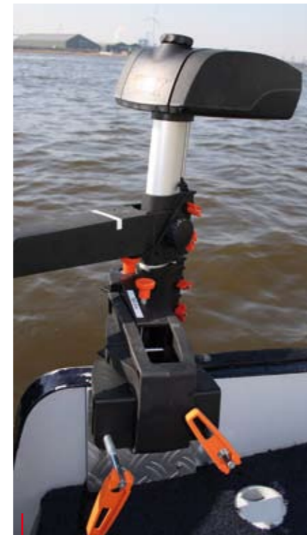
De geïntegreerde accu houdt het verticalend ruim 5 uur vol. Het is enigszins omslachtig om de motor omhoog te schuiven. Daarvoor moeten twee schroeven worden losgedraaid.
